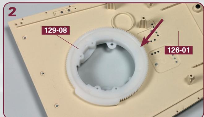
Das Zahnrad **129-08** wird so in der Aussparung des Oberdecksteils **126-01** ausgerichtet, dass das kleine Dreieck direkt nach achtern, also in Richtung Heck, weist. Der Pfeil weist auf das Dreieck.
