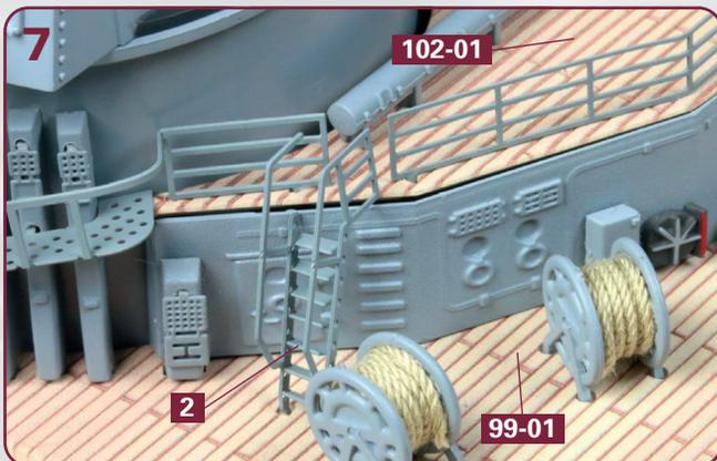
Die Leiter **2** wird an der gleichen Stelle auf der Steuerbordseite der achteren Aufbauten festgeklebt. Sie führt ebenfalls vom Oberdeck **99-01** hinauf zum Deckbelag des Aufbaudecks **102-01**.
