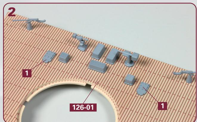
Im vorderen Bereich vom Oberdeckabschnitt **126-01** werden zwei weitere der Oberlichter **1** aus dem Rahmen **127-02** festgeklebt.
