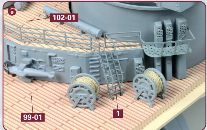
Die Leiter **1** wird auf der Backbordseite der achteren Aufbauten festgeklebt. Sie führt vom Oberdeck **99-01** hinauf zum Deckbelag des Aufbaudecks **102-01**, wie abgebildet.
