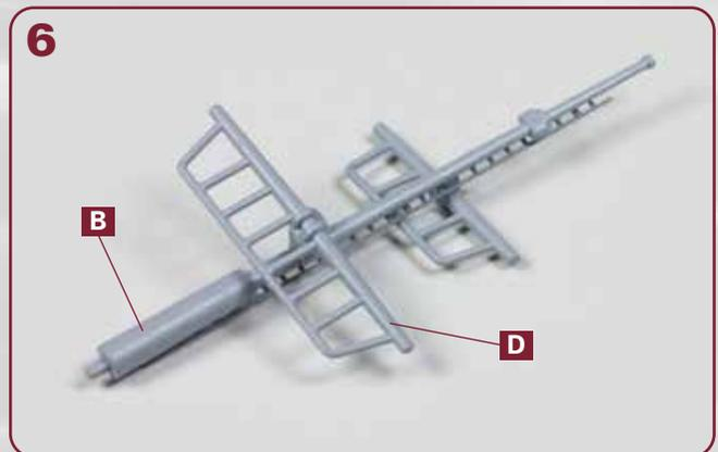
Die Rah **D** ist im unteren Bereich des Mastabschnitts **B** festgeklebt. Achten Sie bei den Rahmen darauf, dass sie parallel zueinander verlaufen.
