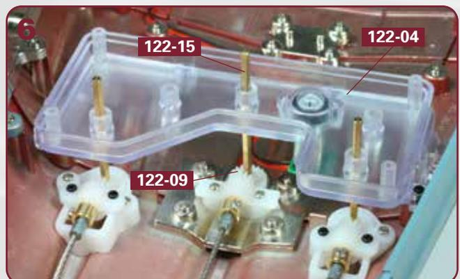
Die Welle **122-15** wird in die zentrale Bohrung des Getriebe-Unterteils **122-04** eingefügt und endet ebenfalls in der Aufnahme eines Zahnrads **122-09**.
