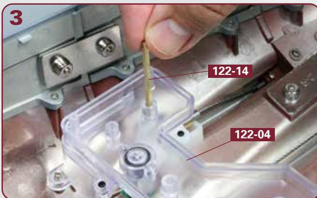
Fügen Sie eine der beiden Wellen **122-14** in die rechte hintere Bohrung des Getriebe-Unterteils **122-04** ein.
