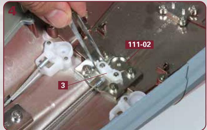
Trennen Sie die Halterung **3** aus dem Rahmen **122-13** und platzieren Sie sie auf den beiden Zapfen des Verbindungsstücks **111-02**.
