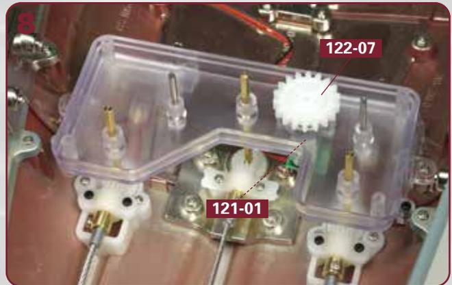
Nehmen Sie das Zahnrad **122-07** und setzen Sie seine zentrale Öffnung auf die Nabe des Motors **121-01**, der am Getriebe-Unterteil befestigt wurde.
