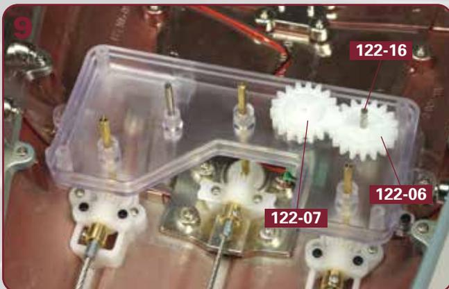
Setzen Sie das Zahnrad **122-06** auf die rechte Welle **122-16**. Seine Zähne greifen in die Zähne des Zahnrads **122-07**, wie abgebildet.
