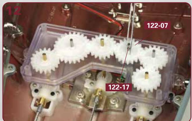
Die kurze Welle **122-17** wird in die zentrale Bohrung des Zahnrads **122-07** eingefügt.
