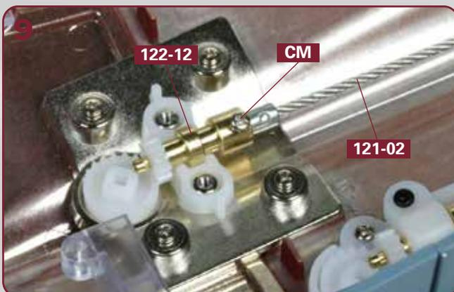
Fügen Sie das Ende der Welle **121-02** in die Öffnung der Wellenaufnahme **122-12** ein und fixieren Sie es mit einer Schraube **CM**.
