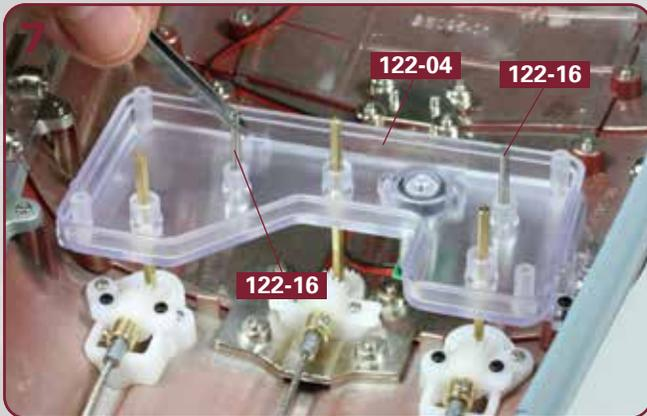
Fügen Sie die beiden Wellen **122-16** in die linke und die rechte freie Bohrung des Getriebe-Unterteils **122-04** ein, wie abgebildet.
