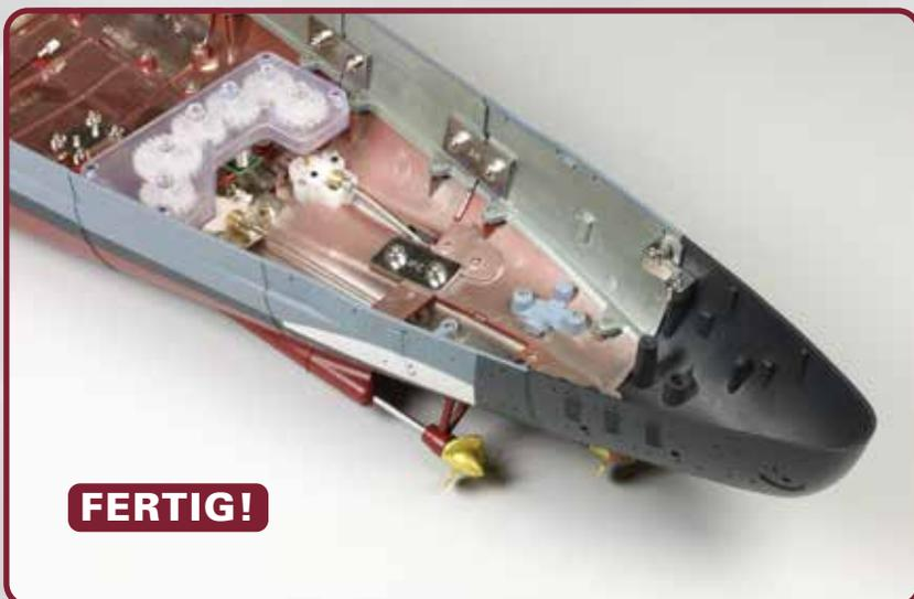
**Das Bauergebnis dieser Ausgabe:** Die drei Propeller-Wellen wurden mit Aufnahmen gesichert und mit dem zusammengebauten Getriebe für die Propeller verbunden.
