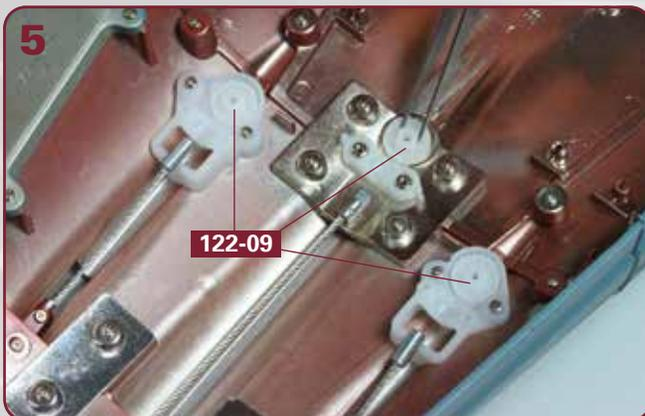
Die drei Zahnräder **122-09** werden in die kreisrunden Aussparungen der zwei Halterungen bzw. des Verbindungsstücks eingesetzt, wie abgebildet.
