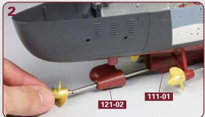
Fügen Sie das vordere Ende der Welle vom mittleren Propeller **121-02** in die zentrale Öffnung am Kielabschnitt **111-01** ein, wie abgebildet.
