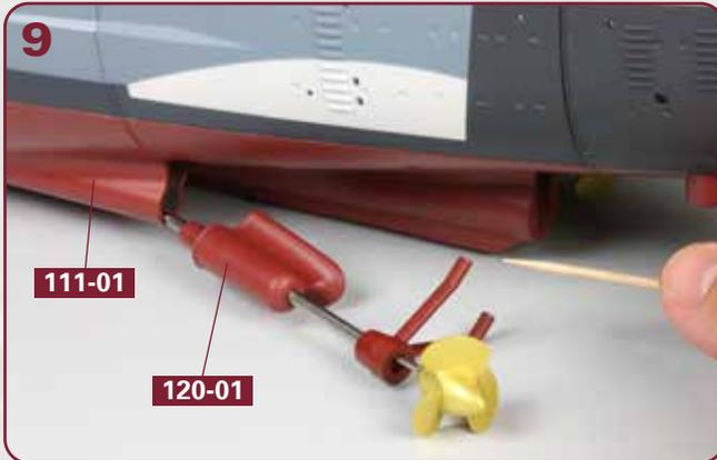
Jetzt ist der linke Propeller **120-01** an der Reihe: Fügen Sie seine Welle in die linke Öffnung am Kielabschnitt **111-01** ein und versehen Sie die beiden Enden des Wellenbocks mit etwas Klebstoff.
