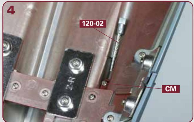
Das zum rechten Propeller **120-02** gehörende Stevenrohr wird ebenfalls mit einer Schraube **CM** in der achteren Position befestigt.
