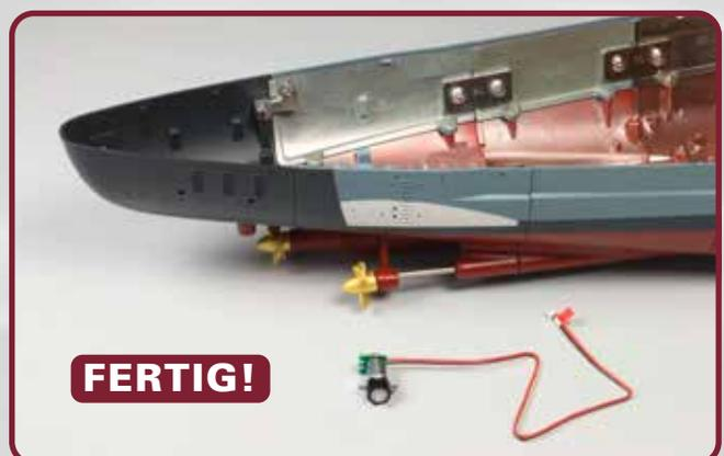
**Das Bauergebnis dieser Ausgabe:** Die drei Propeller-Baugruppen wurden am Rumpf befestigt. Der Motor wird in der folgenden Anleitung montiert.
