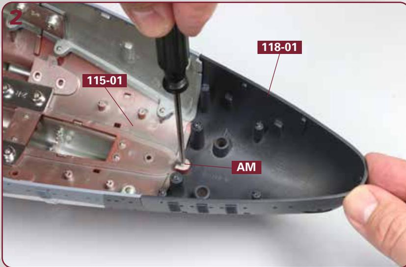
Befestigen Sie das Heck **118-01** am Rumpfabschnitt **115-01**, indem Sie eine Schraube **AM** in die Lasche des Rumpfabschnitts eindrehen.
