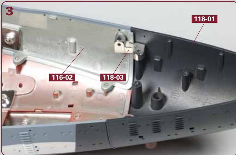
Platzieren Sie das rechte Verbindungsstück **118-03** auf den Zapfen des rechten oberen Rumpfabschnitts **116-02** und des Hecks **118-01**, wie es das Foto zeigt.
