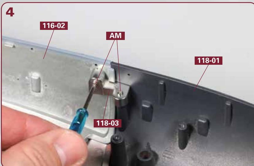
Fixieren Sie das rechte Verbindungsstück **118-03** mit jeweils einer Schraube **AM** am rechten oberen Rumpfabschnitt **116-02** und am Heck **118-01**.
