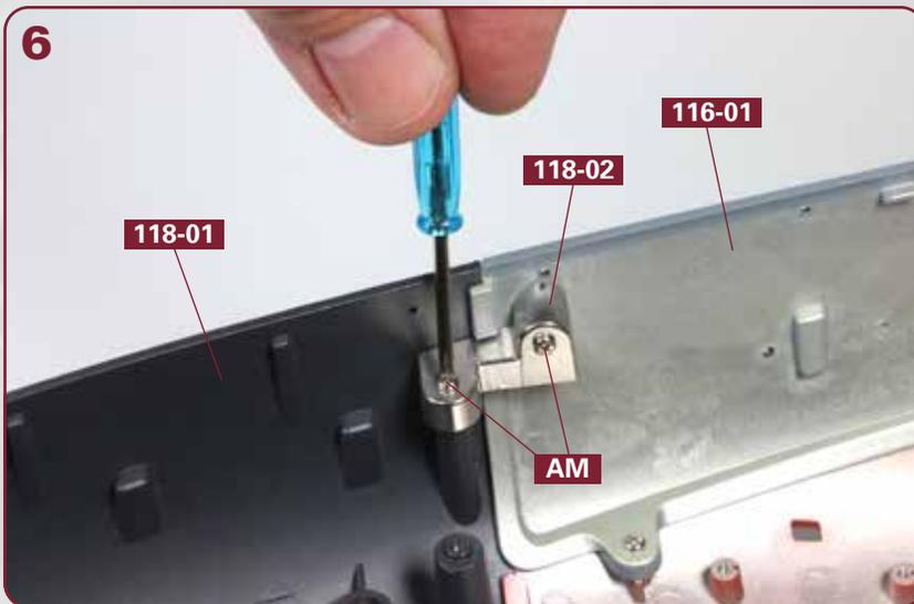
Befestigen Sie das Verbindungsstück **118-02** mit je einer Schraube **AM** an den Zapfen des linken oberen Rumpfabschnitts **116-01** und des Hecks **118-01**, wie abgebildet.
