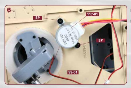
Befestigen Sie den Schrittmotor 117-01 mit zwei Schrauben EP am Decksteil 99-01.
