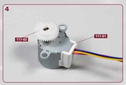
Setzen Sie das Zahnrad **117-02** auf den Rotor des Schrittmotors **117-01** und drücken Sie es vorsichtig bis zum Anschlag hinunter.
