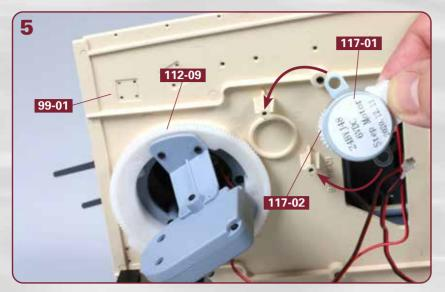
Nehmen Sie die Struktur der achteren Aufbauten. Drehen Sie sie vorsichtig auf die Seite und sichern Sie sie mithilfe einer Halterung (siehe 84. Bauanleitung). Nehmen Sie den Schrittmotor 117-01 und führen Sie seine beiden seitlichen Bohrungen zu den beiden großen Zapfen an der Unterseite des Decksteils 99-01, wie angedeutet. Ist der Motor korrekt aufgesetzt, greifen die beiden Zahnräder 112-09 und 117-02 ineinander.
