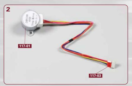
Befestigen Sie die Kabelmarkierung 117-03 am Kabelende des Schrittmotors 117-01, wie es das Foto zeigt.
