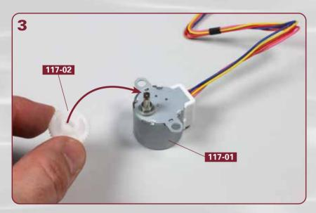
Nehmen Sie das Zahnrad **117-02** und führen Sie es zum Rotor des Schrittmotors **117-01**, wie angedeutet.
