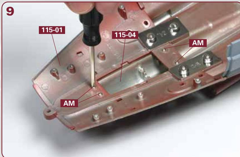
Befestigen Sie den Rumpfabschnitt **115-04** mit den vier Schrauben **AM** am Rumpfabschnitt **115-01**.
