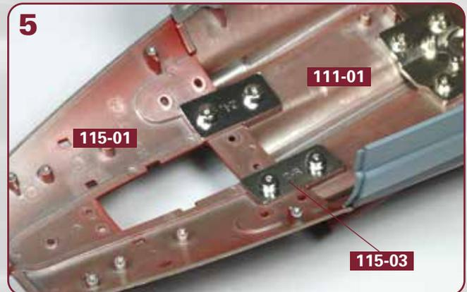
Fügen Sie das Verbindungsstück **115-03** in die andere Vertiefung der Teile **111-01** und **115-01** ein. Achten Sie wieder auf die Ausrichtung des Verbindungsstücks.
