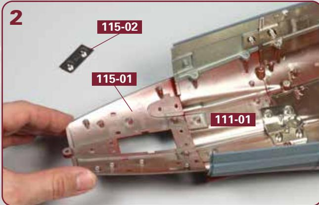
Der Rumpfabschnitt **115-01** ist korrekt mit dem Kielabschnitt **111-01** zusammengefügt. Legen Sie das Verbindungsstück **115-02** bereit.
