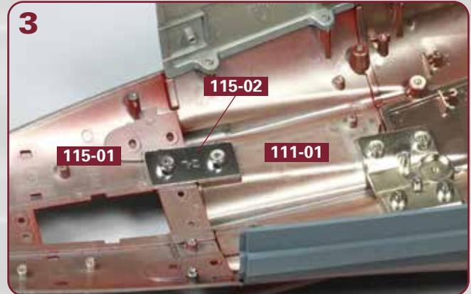
Platzieren Sie das Verbindungsstück **115-02** in der linken Vertiefung der Teile **111-01** und **115-01**. Achten Sie dabei auf die Ausrichtung des Verbindungsstücks.
