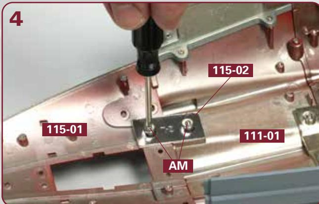
Fixieren Sie das Verbindungsstück **115-02** mit zwei Schrauben **AM** an den Teilen **111-01** und **115-01**, wie abgebildet.
