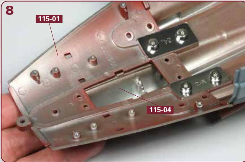
Der Rumpfabschnitt **115-04** ist korrekt unter der Aussparung im Rumpfabschnitt **115-01** platziert.
