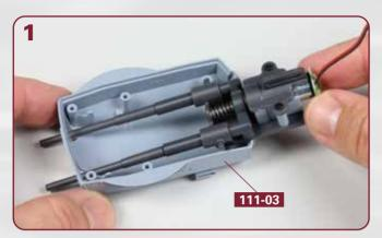
Stellen Sie die Drehhaube **111-03** kopfüber auf Ihre Arbeitsplatte. Setzen Sie die mit der 110. Bauanleitung gefertigte Geschützrohr-Baugruppe in die Drehhaube ein.
