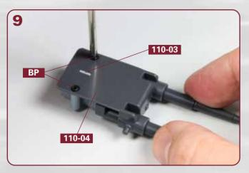
Drehen Sie die Baugruppe um und fixieren Sie das Oberteil der Motorhalterung 110-03 mit den zwei Schrauben BP an der Bodenplatte 110-04.
