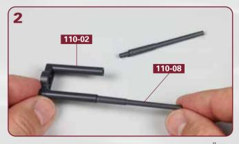
Kleben Sie das erste Rohr 110-08 in der einen Öffnung des Verbindungsstücks 110-02 fest, wie abgebildet.
