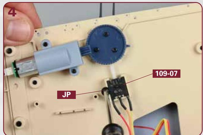
Fixieren Sie den Endschalter **109-07** mit einer Schraube **JP** an der Unterseite des Oberdecks.
