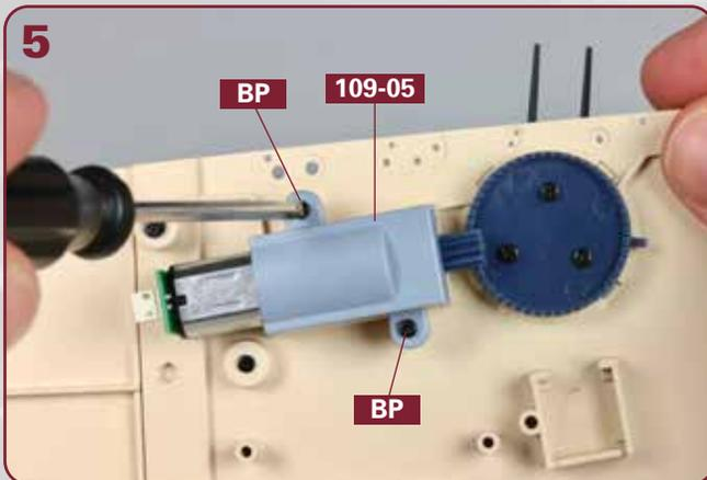
Befestigen Sie die Abdeckung **109-05** mit zwei Schrauben **BP** an der Unterseite des Oberdecks.
