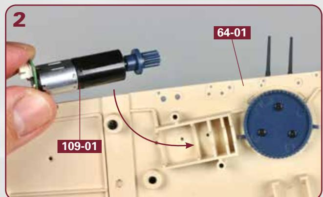
Bocken Sie die achteren Aufbauten vorsichtig auf (siehe auch letztes Foto auf Seite 5). Führen Sie den Schwenkmotor **109-01** zur entsprechenden Halterung an der Unterseite von **64-01**, wie angedeutet.
