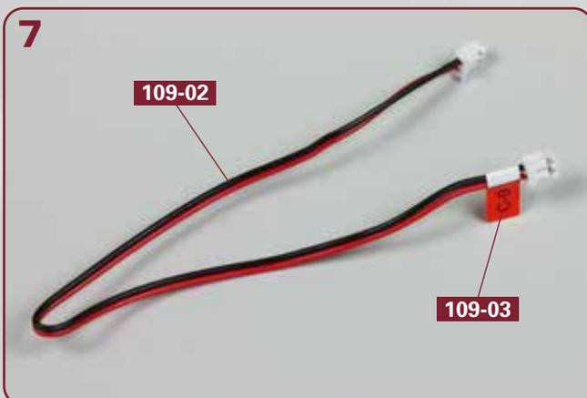
Bringen Sie die Kabelmarkierung **109-03** am Kabel **109-02** an.
