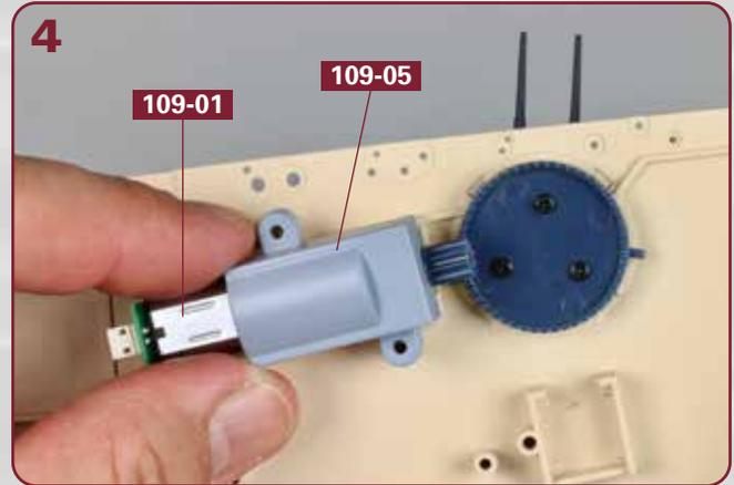
Platzieren Sie die Abdeckung **109-05** über dem Schwenkmotor **109-01**. Ihre Bohrungen müssen mit den Bohrungen am Oberdeck übereinstimmen.
