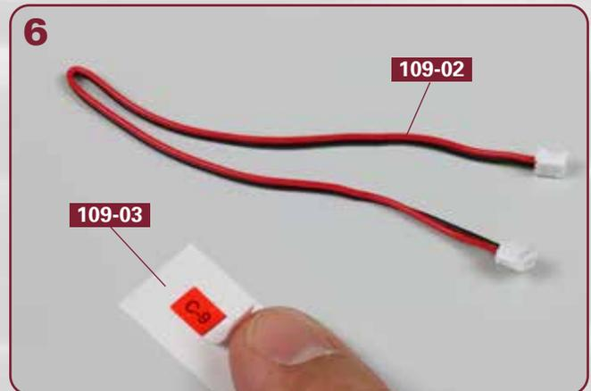
Legen Sie das Kabel für den Schwenkmotor **109-02** auf Ihre Arbeitsplatte. Lösen Sie die Kabelmarkierung **109-03** vorsichtig vom Trägerkarton.
