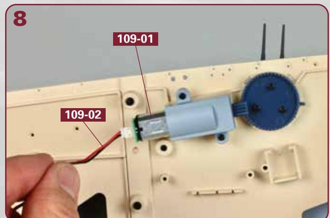
Fügen Sie den (nicht markierten) Stecker vom Kabel **109-02** in den Platinenport des Schwenkmotors **109-01** ein, wie abgebildet.
