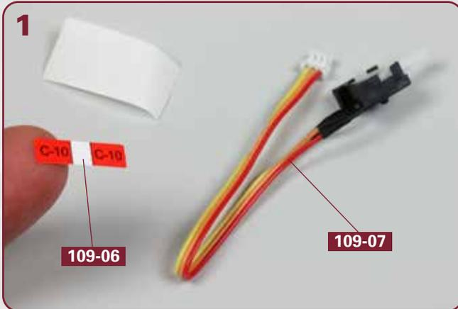
Legen Sie das Kabel des Endschalters **109-07** bereit. Lösen Sie die Kabelmarkierung **109-06** vorsichtig vom Trägerkarton.
