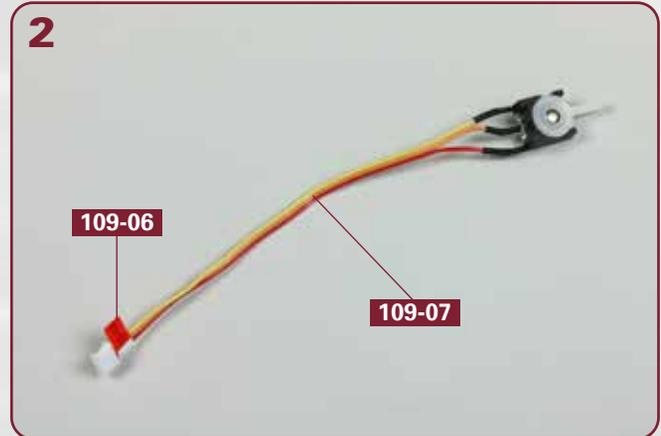
Kleben Sie die Kabelmarkierung **109-06** am Kabel des Endschalters **109-07** fest.
