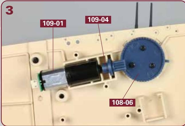
Ist der Motor **109-01** korrekt eingesetzt, greifen die Ritzel des Antriebszahnrad **109-04** in das Zahnrad **108-06**, wie abgebildet.
