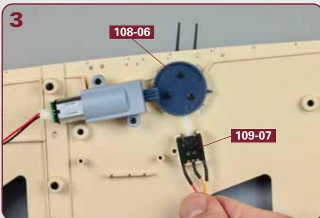
Platzieren Sie den Endschalter **109-07** nahe des Zahnrads **108-06** in der Aussparung an der Unterseite des Oberdecks.
