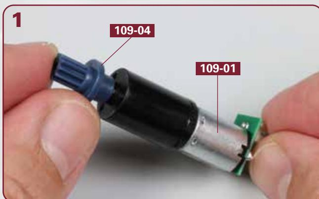
Nehmen Sie das Antriebszahnrad **109-04** und setzen Sie es auf die Welle des Schwenkmotors **109-01**, wie es das Foto zeigt.
