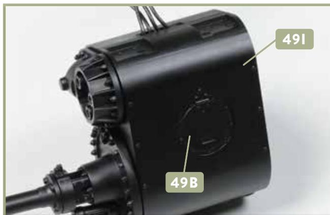
**8** Der Verschluss **49B** wird an der Zylinderblockverkleidung **49I** befestigt: Drücken Sie dazu die Zapfen in die entsprechenden Aufnahmen hinein.
