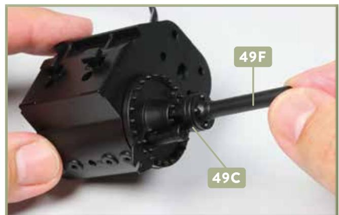
**6** Geben Sie etwas Sekundenkleber auf den Zapfen des Kolbenstangenschutzrohrs 49F und fügen Sie diesen in die Aufnahme der Stopfbuchse 49C ein, wie abgebildet.
