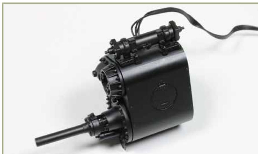
Der Zusammenbau der linksseitigen Steuerung schreitet voran: Zwei Deckel, das Kolbenstangenschutzrohr und der Druckausgleichler wurden am Zylinderblock angebracht.
