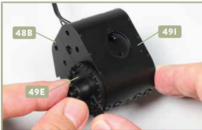
**3** Drücken Sie die zwei Zapfen an der Innenseite des Zylinderdeckels 49E in die Aufnahmen der Verkleidungen 48B bzw. 49I hinein. Es handelt sich um eine Steckverbindung.
